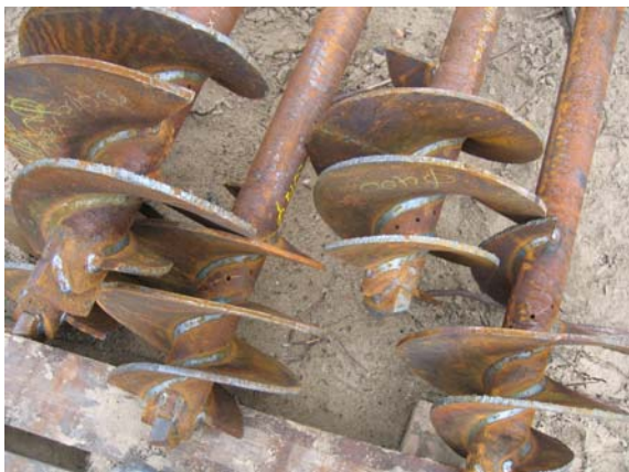
Afb. 1 Schroefblad aan uiteinde van de stalen paal; tussen de schroefbladen zijn de gaten zichtbaar
