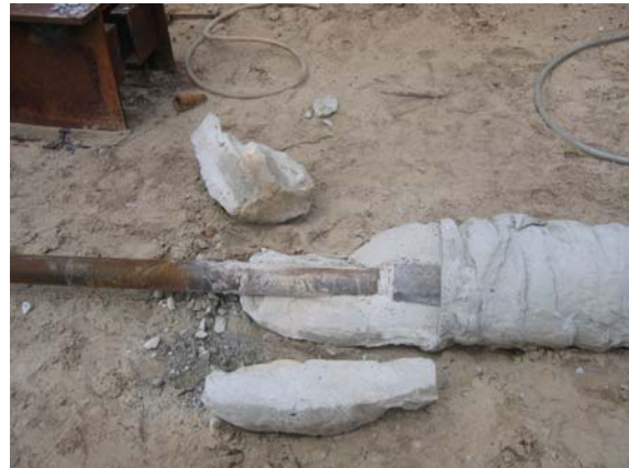
Afb. 2 Stalen paal en schroef met grout eromheen
